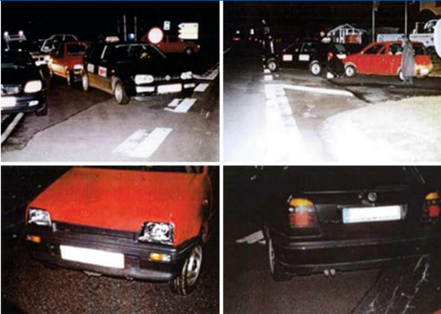
**Abb. 6** ▲ Auffahrunfall zum Urteil des OLG Bamberg: Am VW Golf waren Stoßfänger und Heckblech leicht angedrückt, am Daihatsu Cuore waren Stoßfänger und Frontblech leicht angedrückt sowie ein Scheinwerfer zertrümmert
