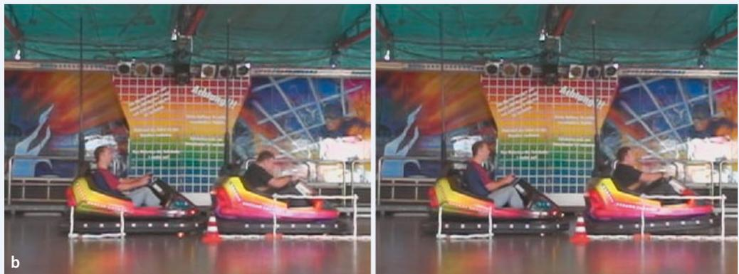
**Abb. 5** ▶ **a** Belastungswerte des Probanden (Geschwindigkeitsänderung  $\Delta v = 10,4$  km/h) bei der Heckkollision der Scooter (**b**)
